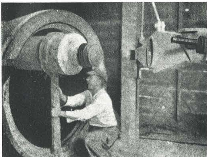
FOTO N.º 5.- Introducido el árbol en el interior del molde, se sujetan los extremos del rodillo, mediante unas piezas exteriores que pueden girar alrededor de unos ejes verticales. Sobre dichas piezas van a apoyarse las cabezas del eje del árbol que, durante el vertido del hormigón, da vueltas arrastrando en su movimiento el molde. La tubería de 1'40 m. de diámetro, que se describe en este artículo, es la mayor de las fabricadas por este nuevo procedimiento.
