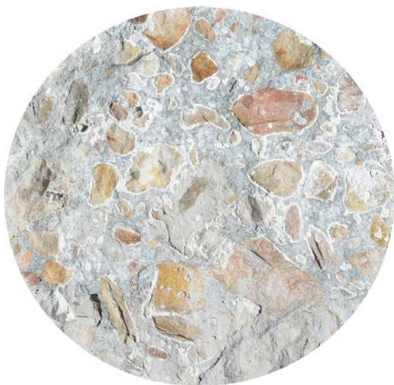
Figura 28. Probeta con aureolas de gel en la interfaz árido-pasta. Foto cortesía del Laboratorio de Química de la Escuela de Ingenieros de Caminos, C. y P. de Madrid, no incluida en [11].
