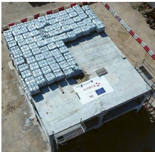
Figura 11. Foto del edificio de hormigón prefabricado construido dentro del proyecto ENDURE antes del ensayo.
