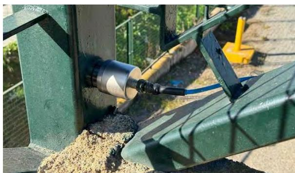
Figura 2. Acelerómetro instalado.
