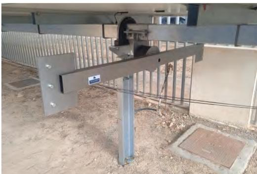
Figura 1. Fotografía del prototipo de TMD montado sobre seguidor solar.
