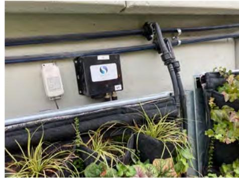
Figura 2. A la izquierda dispositivo con los sensores de HR y Tª y a la derecha el que contiene los sensores de corrosión.
