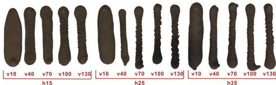
Figura 2. Probetas impresas con la mezcla de referencia para verificar la extruibilidad.
