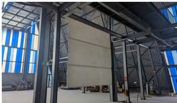
Figura 2. Fotografía de los ensayos de vibración libre de una muestra de lona de la cubierta retráctil en el laboratorio LACIAD de Oritia & Boreas.
