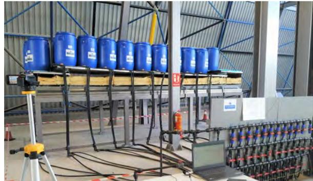
Figura 2. Banco de ensayos para las pruebas de carga de la muestra real de fachada.
