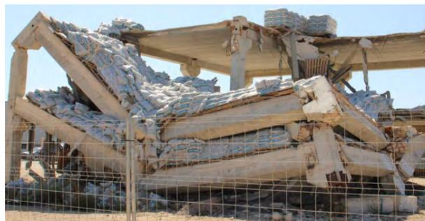
Figura 2. Estado del edificio tras la Fase 2 del ensayo experimental.
