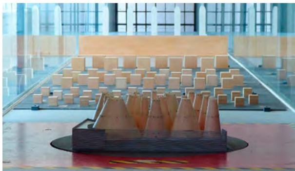
Figura 2. Modelo físico del edificio para túnel de viento.
