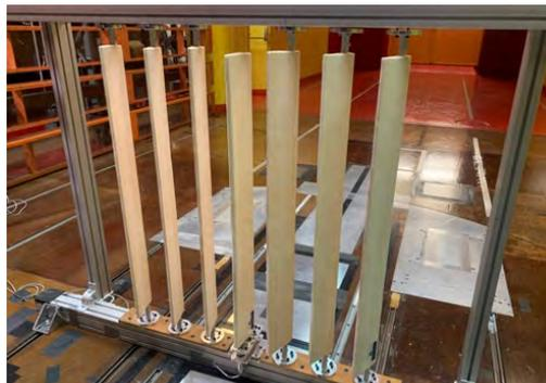
Figura 2. Modelo de las piezas prismáticas de la piel exterior a escala 1:3.
