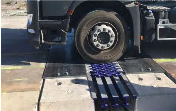
Figura 1. Evaluación dinámica de la junta de dilatación modular: un ejercicio complejo en términos de amplificación dinámica y factores de repunte, que requiere experiencia especializada en medición y análisis de datos.
