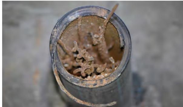
Figura 2. Vista frontal del tendón roto con algunas roturas frescas en los alambres.
