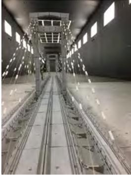
Figura 1. Modelo aeroelástico integral Ampliación Puente de Rande, los dos cajones laterales se unen articulados al central del puente original (Oritia&Boreas, 2017).
