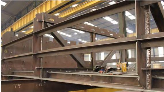
Figura 1. Ejecución en taller metálico en acero autopatinable.
