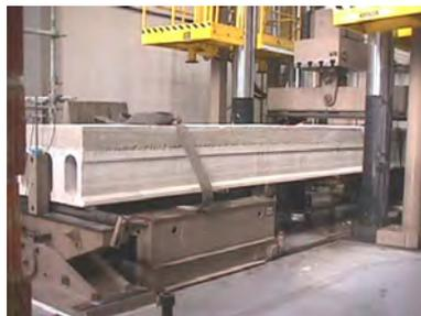
Figura 2. Placa alveolar pretensada con capa de compresión armada, para forjados.
