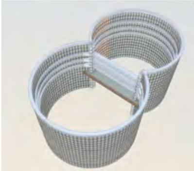
Figura 1. Modelo en 3D de la pantalla de pilotes.
