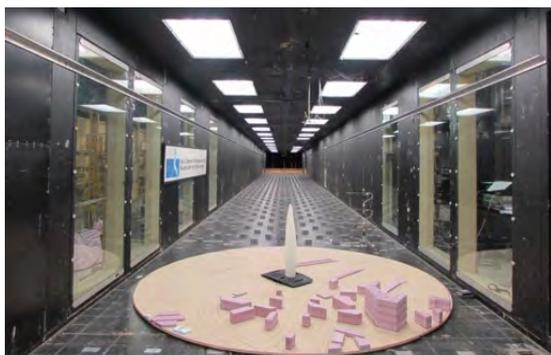
Figura 1. Fotografía del modelo de balanza en el túnel de viento con la planificación futura.
