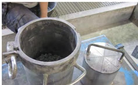
Figura 1. Ensayo de empaquetamiento en fibra y árido.
