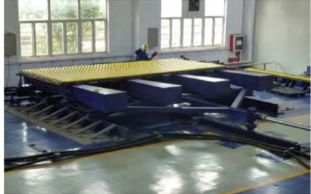
Figura 2. Ensayo de movimiento a escala real de una junta de dilatación modular de 18 brechas, con combinaciones de desplazamientos longitudinales, transversales y verticales.
