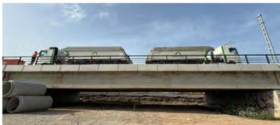
Figura 1. Realización de prueba estática en el puente de acceso ferroviario a la Terminal T1 del Aeropuerto Josep Tarradellas Barcelona-El Prat.
