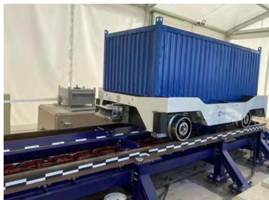
Figura 2. Prototipo del Sistema Automatizado de Transporte de Mercancías.
