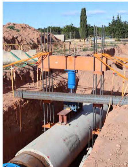
Figura 2. Configuración del ensayo de aplastamiento del tubo de hormigón armado.
