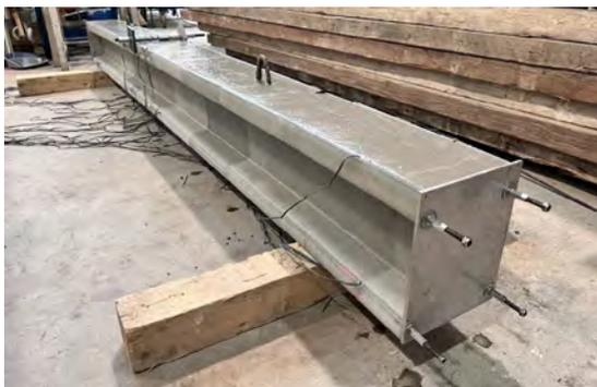
Figura 1. Prototipo viga híbrida plástico - Hormigón.
