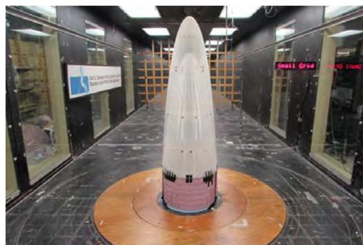
Figura 1. Fotografía del modelo de sección en el túnel de viento con la planificación futura.
