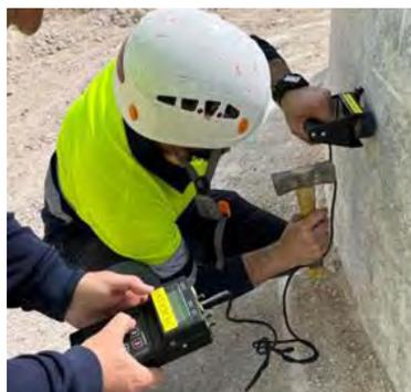
Figura 2. Realización de ensayo de impacto-eco.
