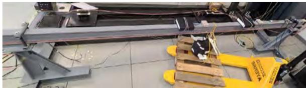
Figura 1. Montaje experimental de la viga de 3.5 m.
