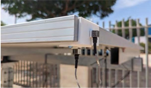
Figura 1. Detalle de la disposición de acelerómetros en seguidor solar.
