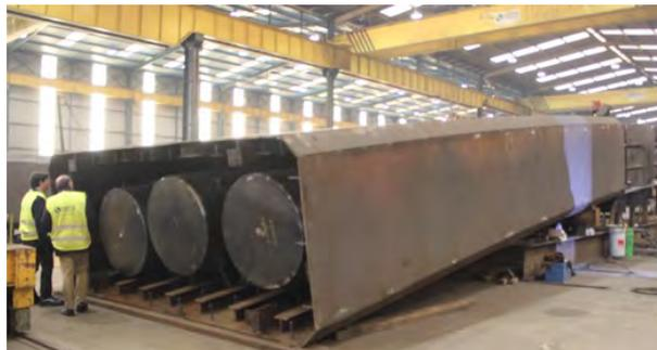
Figura 2. Tramo del arco mixto en el taller metálico.
