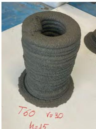
Figura 1. Cilindro hueco impreso con la mezcla de referencia para verificar la viabilidad de impresión.
