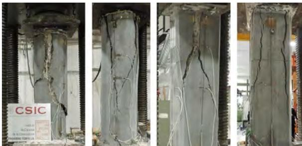
Figura 1. Varias probetas tras el ensayo: a) circular con camisa de 1150 mm; b) circular reforzada en toda la altura; c) cuadrada con camisa de 1150 mm y d) cuadrada reforzada en toda la altura.
