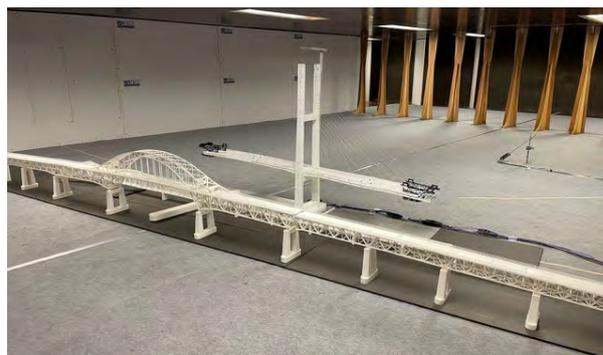
Figura 2. Pattullo Bridge – Ensayos de túnel de viento.
