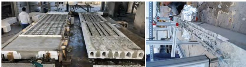
Figura 1. Construcción de especímenes de ensayo para campañas: (a) a flexión; (b) a cortante.
