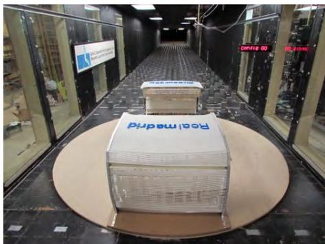
Figura 1. Fotografía de los ensayos en túnel de viento de capa límite del modelo seccional norte y sur a escala 1:80 del nuevo estadio Santiago Bernabéu.
