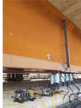
Figura 2. Pruebas de carga en parque previas al lanzamiento.
