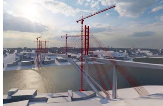
Figura 2. Infografía del procedimiento constructivo.
