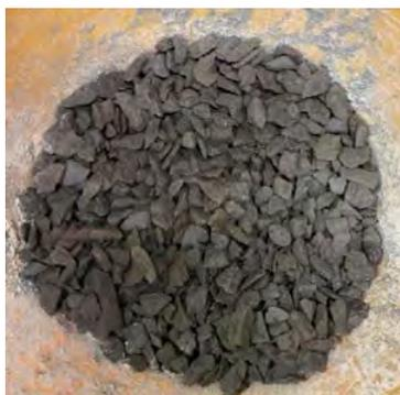
Figura 1. Residuos de las minas de carbón.
