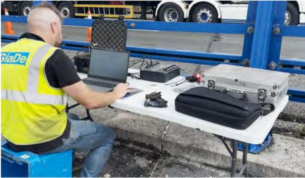
Figura 1. Registro al paso de vehículo pesado sobre la junta.
