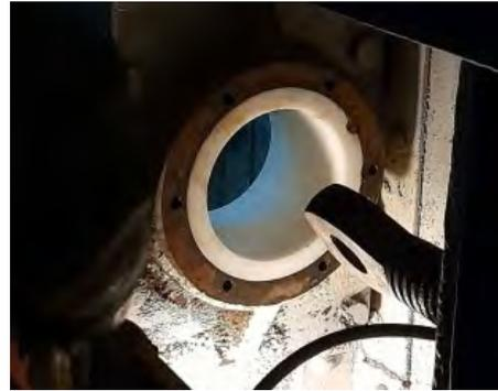
Figura 2. Desplazamiento manual del bulón para la sustitución de los casquillos de alojamiento.
