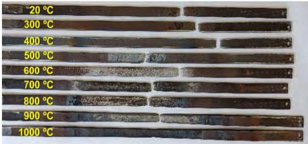
Figura 1. Aspecto de las probetas de acero S355 tras los ensayos post-fuego.
