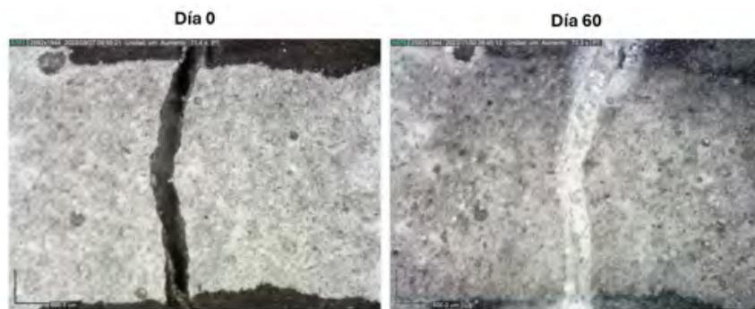
Figura 1. Sellado de fisura en mortero con ceniza de madera y bacterias tras 60 días de curado.
