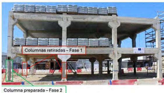
Figura 1. Estado del edificio tras la Fase 1 del ensayo experimental.
