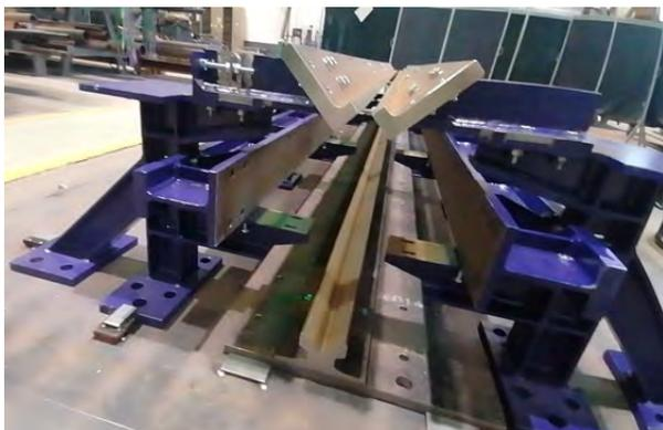
Figura 1. Estructura soporte del motor lineal en taller.
