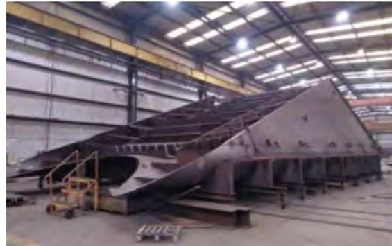
Figura 2. Fabricación en taller de la estructura metálica del bulbo del tablero del puente.
