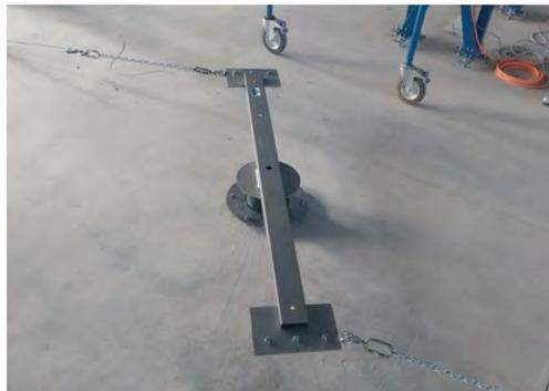
Figura 2. Fotografía del prototipo de TMD fabricado para ensayos.
