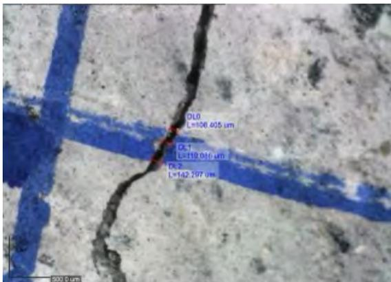
Figura 1. Fisura en el hormigón sostenible con cenizas de biomasa y áridos porosos de cenizas de carbón: fisura generada mediante el ensayo de tracción indirecta.
