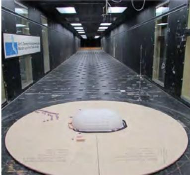
Figura 1. Fotografía del modelo en el ensayo en túnel de viento de capa límite.
