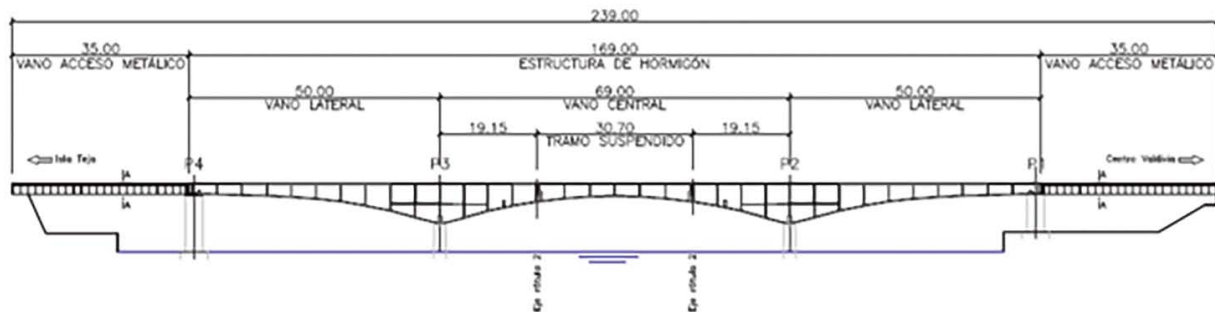
Figura 4. Alzado del puente.
