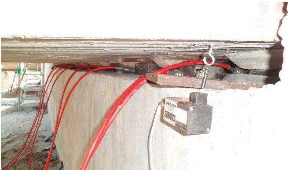
Figura 8. Sensor de desplazamiento instalado para control de la maniobra.
