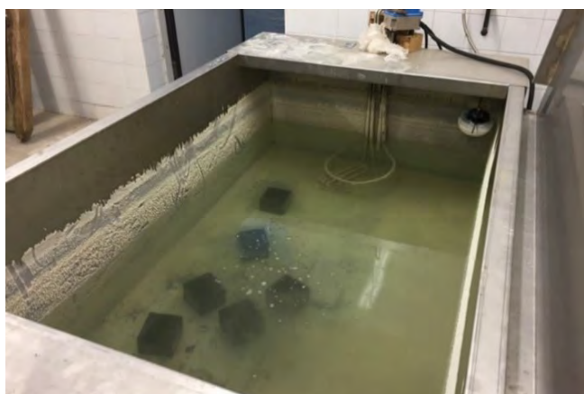
Figura 2. Enfriamiento en agua de las probetas.
