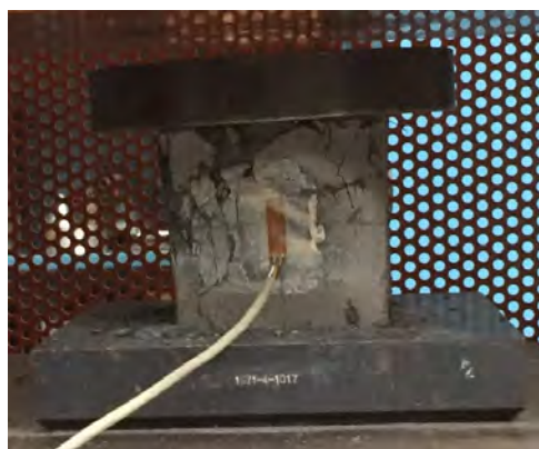
Figura 3. Probeta con banda extensométrica sometida a ensayo a compresión simple.
