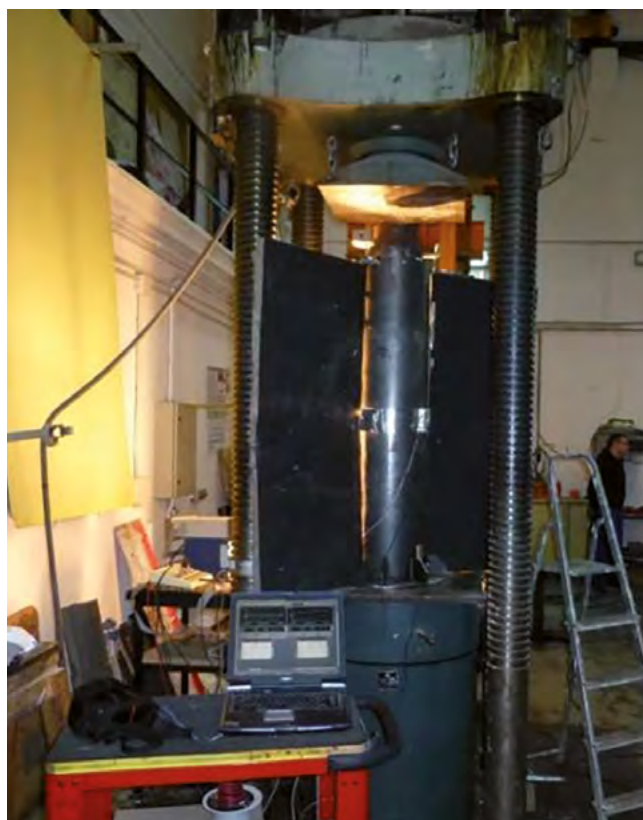
Figura 12. Ensayo de un tubo con calentamiento diferencial.
