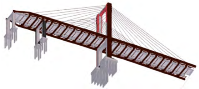
Figura 7. Puente del Centenario. Sustitución de tirantes (FHECOR-IDEAM).
