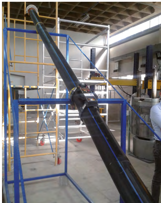
Figura 6. Ensayo de calibración de “sonda capacitiva” en un tirante de prueba montado en laboratorio.
