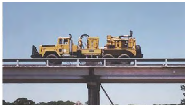
Figura 18. Ensayo dinámico de la pila de un puente mediante vibrador sísmico. Fuente: [21].
