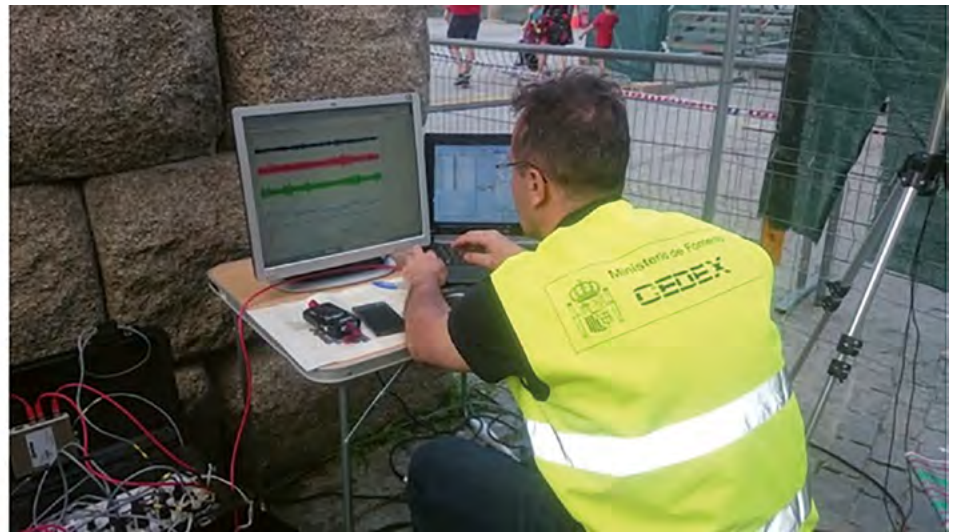
Figura 21. Estudio de vibraciones en el Acueducto de Segovia (2018).
