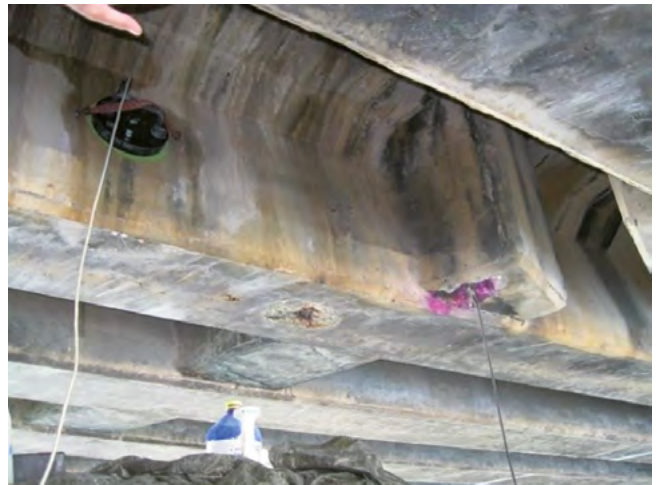
Figuras 5 y 6. A la izquierda, inspección detallada con camión pasarela. A la derecha, determinación in-situ de los parámetros de corrosión, en el marco de una inspección especial. Fuente: GEOCISA.
