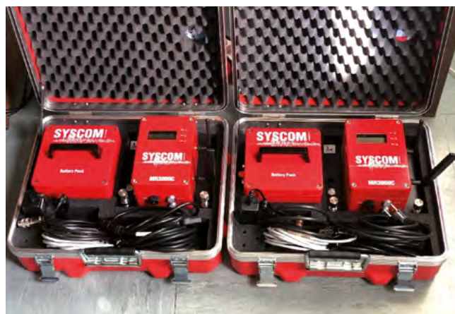
Figura 17. Equipos de medida de aceleraciones inalámbricos para análisis modal. Fuente: GEOCISA, 2021.
