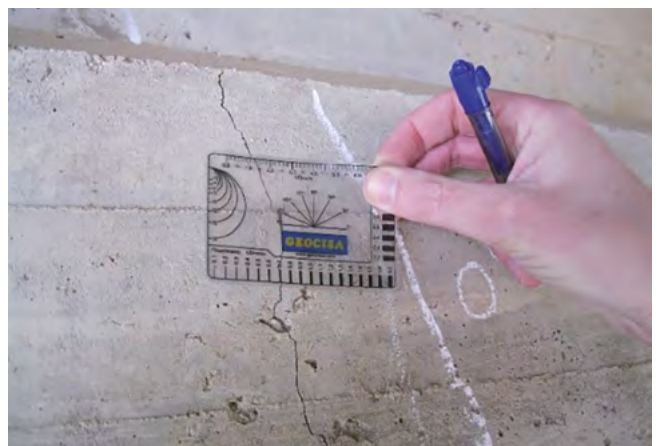
Figuras 7 y 8. En una inspección visual se pueden evaluar los deterioros de forma cualitativa, y a veces parcialmente cuantitativa (la pérdida de sección de una armadura o la longitud y anchura de las fisuras), pero difícilmente se puede conocer la influencia del daño en el desempeño del elemento. Fuente: GEOCISA.
