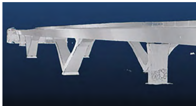
Figura 24. Modelo geométrico 3D del puente existente.
