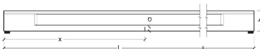
Figura 4. Vista longitudinal de la viga, con los parámetros de definición de la fisura.
