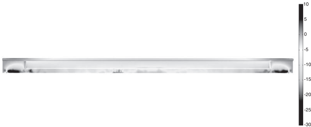
Figura 6. Tensiones longitudinales [MPa] en la viga con una fisura en x/l=0,40 y de profundidad a/h=0,25 .
