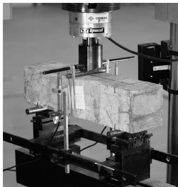
Figura 1. Ensayo de energía de fractura sobre probeta de 10 x 10 x 40 cm entallada
