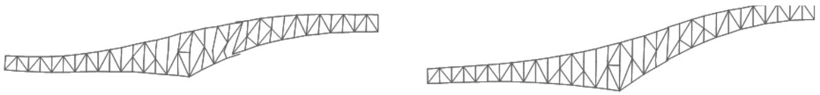
Figura 45. Deformada del estado por cargas permanentes, sin corrección de geometría y con corrección geométrica por temperatura Figure 45. Deformed state to permanent loads, without correction of geometry and with geometric correction for temperature
