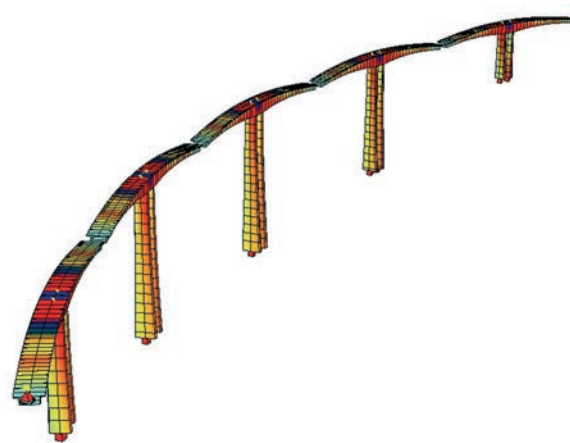
Figura 14. Modelo evolutivo para el cálculo general del viaducto
