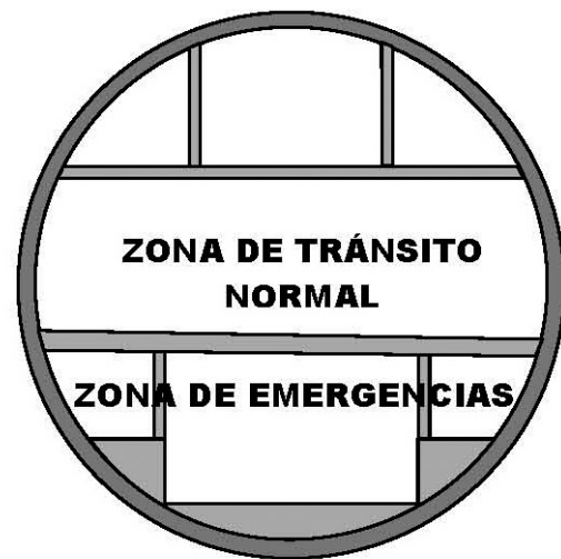
Figura 20. Sectores de fuego en el By-Pass Sur.
