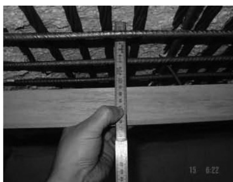
Figura 38. El desconchado máximo fue de 11 cm de la pieza tras el ensayo definitivo.
