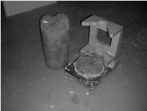
Figura 2. Probeta con 100% de AMR en dosificación, no fue posible el refrentado a 7 días.
