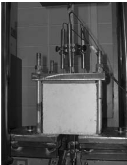
Figura 2. Montaje del ensayo de pull-out.
