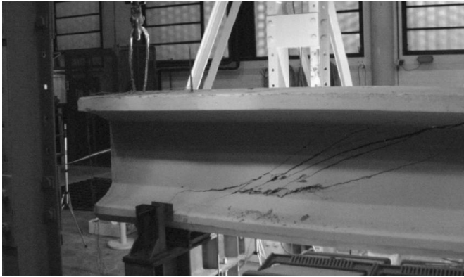
Figura 6. Detalle de la rotura de una viga sin armadura transversal (HAP1W).
