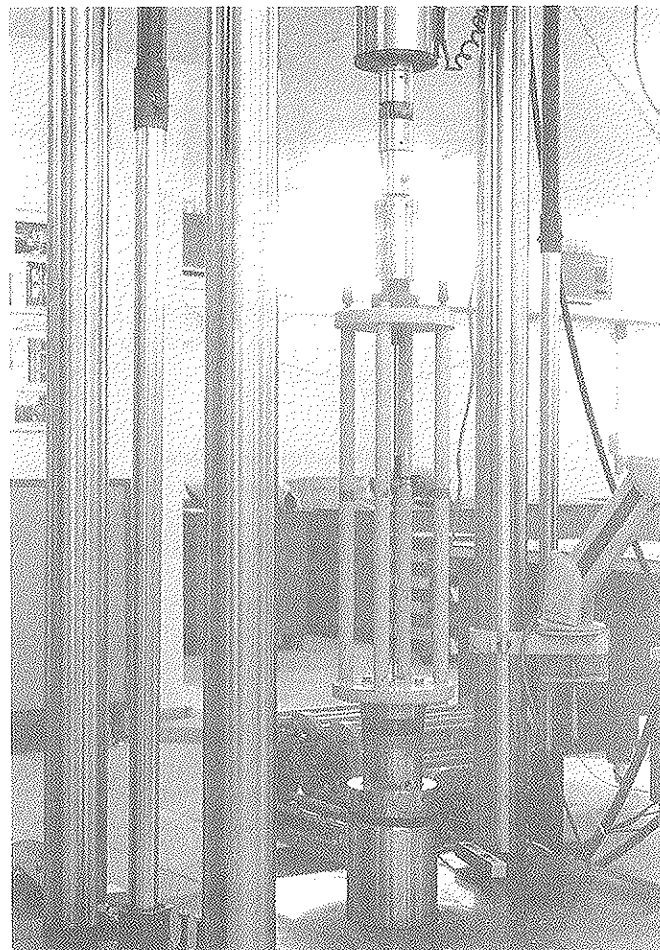
Figura 5. Bastidor en la máquina de ensayos durante el proceso de pretensado del alambre.
