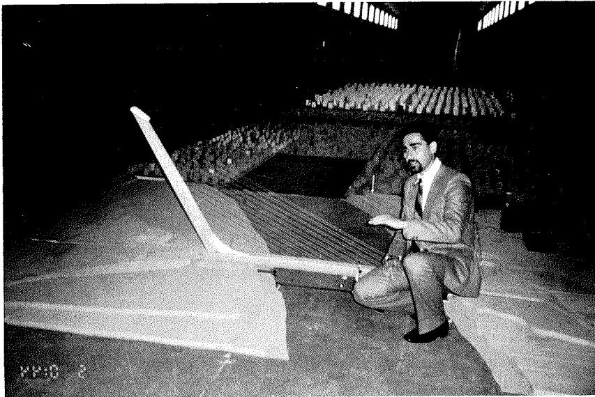
Foto 10. Modelo final utilizado para el estudio de la acción del viento.
