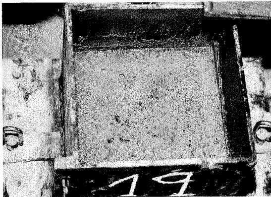
Foto 2: Aspecto de la tongada recién compactada.
