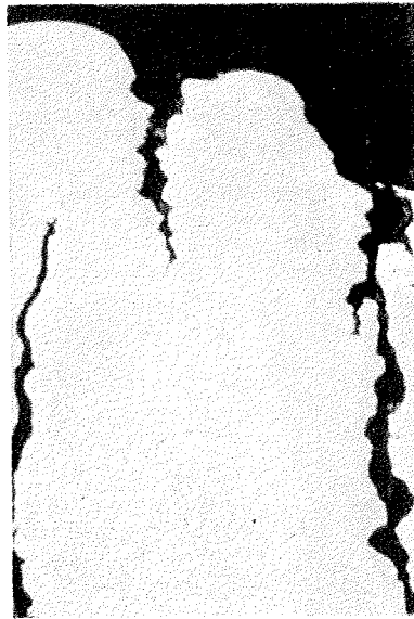
Fig. 9.—Progresión de las fisuras partiendo de los cráteres superficiales.
