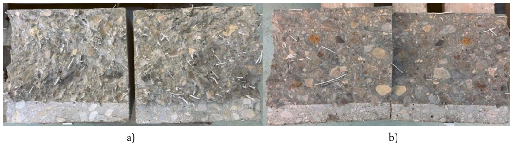
Figura 7. Imágenes de las superficies de rotura de prismas con diferente número de fibras: (a) el mayor número de fibras que atraviesan la sección; (b) el menor número de fibras que atraviesan la sección.
