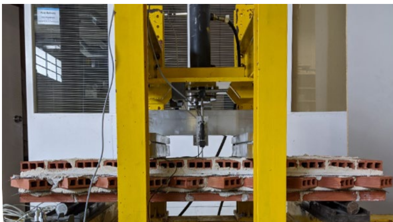
Figura 8. Montaje de la fábrica con refuerzo para el ensayo de flexión a cuatro puntos.
