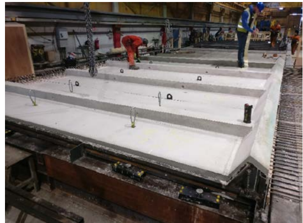
Figura 9. Panel prefabricado de alma inclinada
