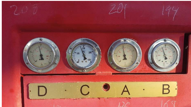
Figura 26. Vista de los barómetros incluidos en los conjuntos SPMT.
