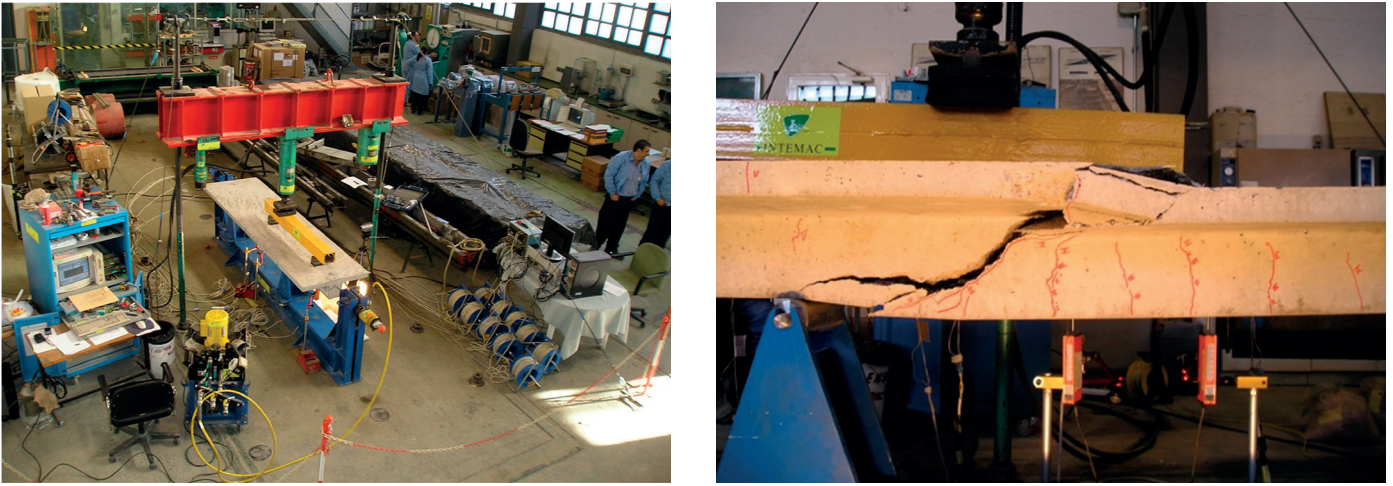
Figura 4. Vista general de disposición de ensayos y de rotura frente a esfuerzo cortante del ensayo V8-025.
