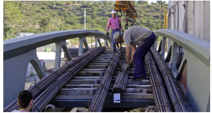
Figura 30. Paquetes de barras apoyados sobre maderas para la prueba de carga estática.
