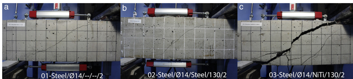
Figura 17. Fotografías de las vigas 01, 02 y 03, señaladas con a, b, y c respectivamente, antes de alcanzar la máxima fuerza resistida, ordenadas de izquierda a derecha.
