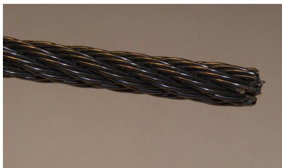
Figura 14. Ejemplo de tendón de Ni-Ti formado por 7 \times 7 alambres de 0,892 mm de diámetro cada uno de ellos.
